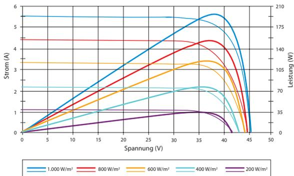
Hervorragende Leistung bei schwachem Licht: bei einer Strahlungsintensität von 200 W/m<sup>2</sup> (Luftmasse 1,5, 25 °C) ist ein relativer Modulwirkungsgrad von mehr als 96% gegenüber Standardtestbedingungen (1.000 W/m<sup>2</sup>) erreichbar.
